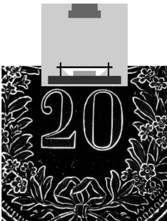
Fig.2 Reliefs et contours d'une pièce de monnaie éclairés par le champ rasant L.E.S.S.
