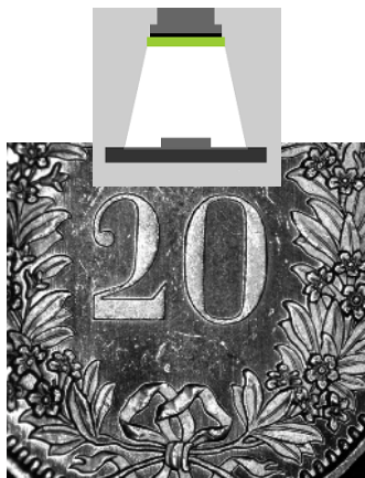
Fig.1 Surface d'une pièce de monnaie éclairée par le champ clair L.E.S.S.
