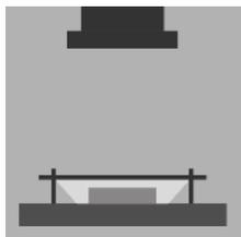
Die VisiDark-Beleuchtungsserie ist für die Inspektion von Oberflächen und Konturen bestimmt und bietet dank der hohen Richtwirkung des Lichts eine außergewöhnlich schnelle Erkennung. Die Inspektion von Proben kann mit dem bloßen Auge oder unter einem Mikroskop für eine detailliertere Inspektion durchgeführt werden. Der Arbeitsabstand ist einstellbar, von einer Dunkelfeld- bis zu einer Streiflichtkonfiguration.
